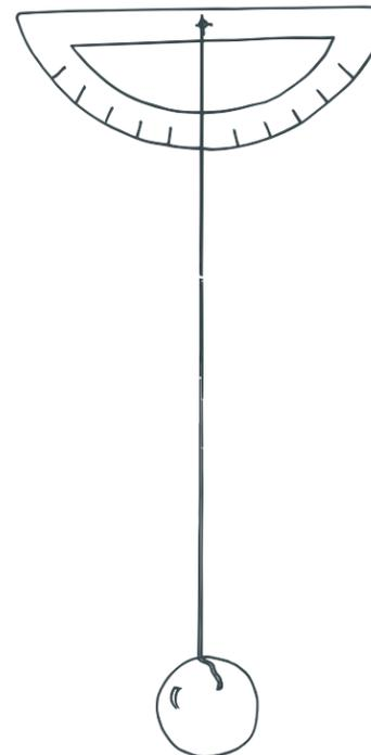
**Anemómetro:** Adhiere con cinta uno de los extremos de un trozo de cuerda a la pelota de ping pong y el otro al centro de la orilla recta del transportador. Sostén el anemómetro con la orilla recta paralela al piso. Observa el ángulo de la cuerda cuando sople el viento, entonces úsalo para calcular la velocidad del viento; revisa la tabla en nuestra plantilla de transportador.
