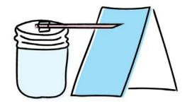
Sostén el anemómetro con el borde recto paralelo al piso. Observa el ángulo de la cuerda cuando sople el viento, entonces úsalo para calcular la velocidad del viento; revisa la tabla en nuestra plantilla de transportador.
